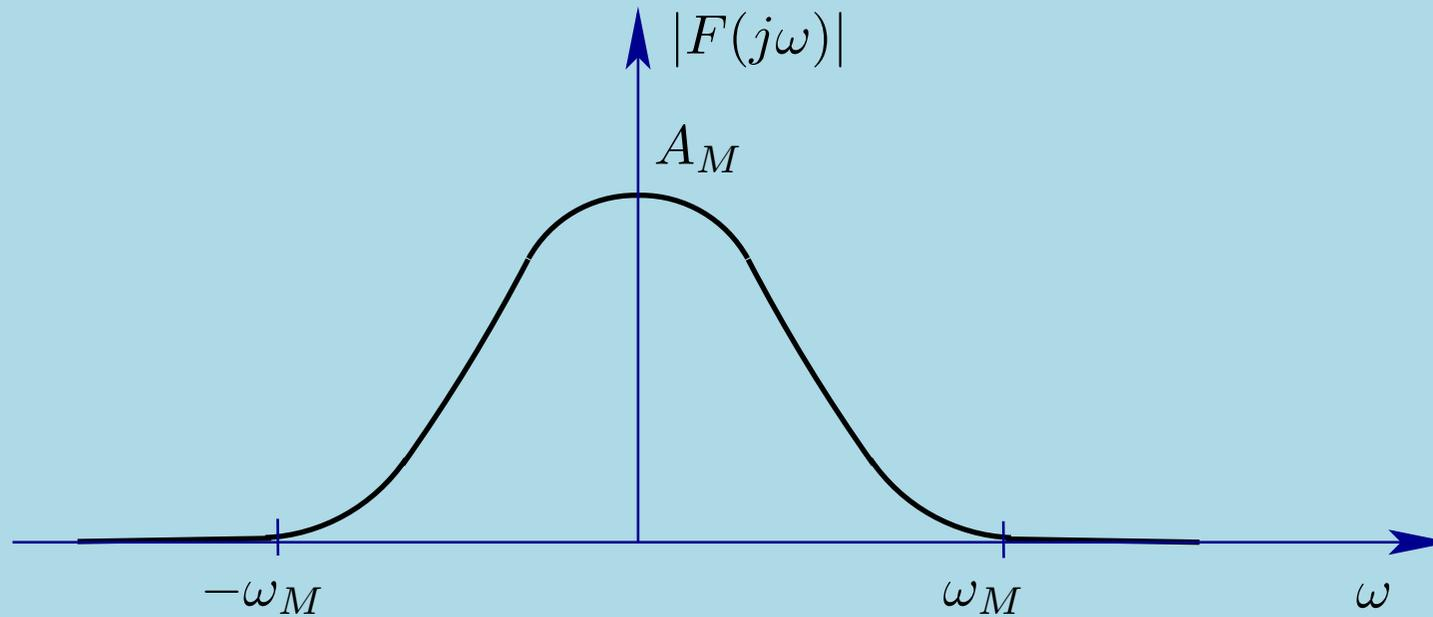
→ spectre du signal échantillonné est obtenu à partir du spectre du signal à temps continu
