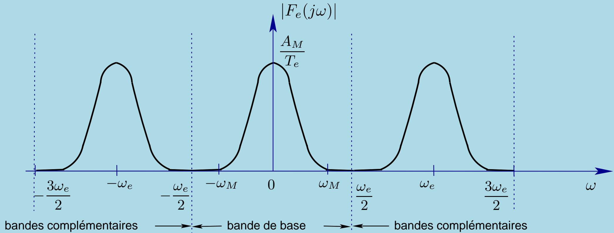
👉 Spectre du signal échantillonné lorsque  $\omega_M > \frac{\omega_e}{2}$
